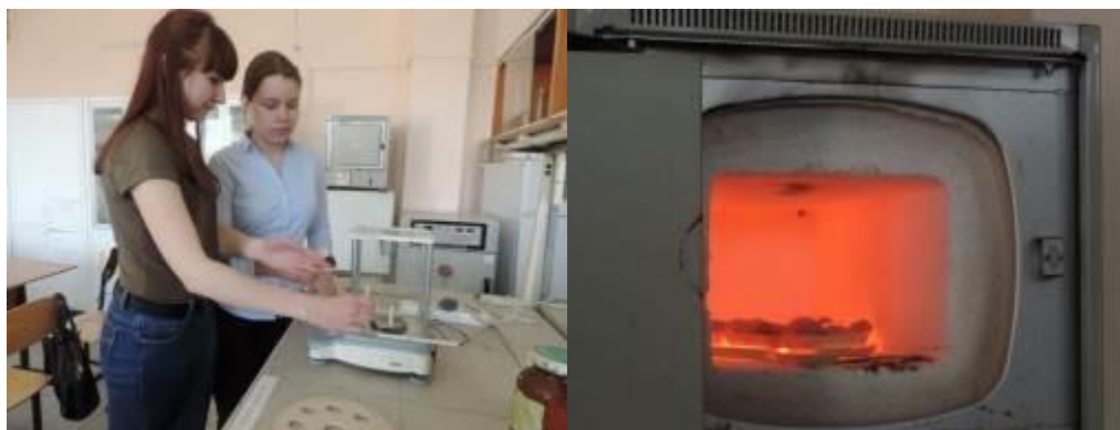
Рис. 15. Запекание капсул в муфельной печи при 900 °С
