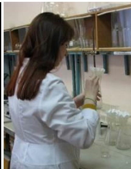
Рис. 9. Фильтрация через складчатый бумажный фильтр
