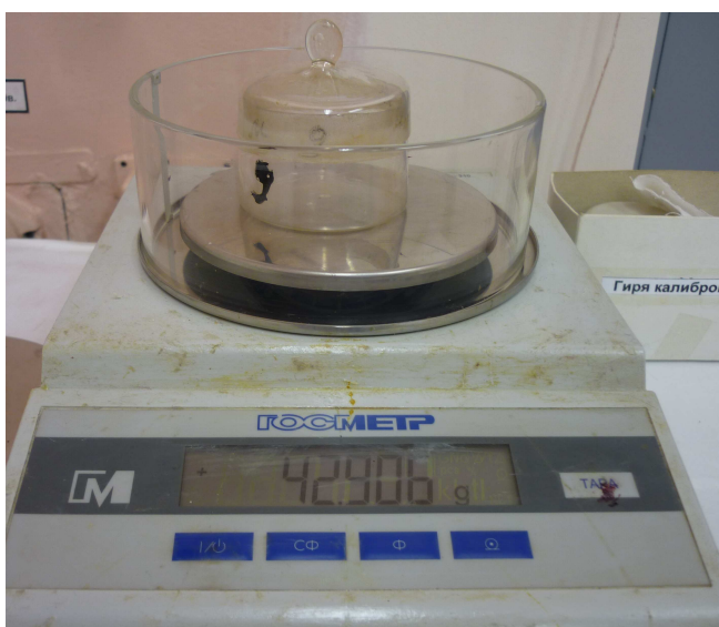
Фото №9-12. Взвешивание пустых бюксов на весах ВЛТЭ-310 с точностью до третьего знака после запятой.
