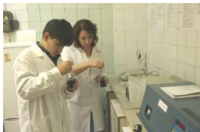
Фото №80-82. Тщательное перемешивание образцов с 1 молярным раствором KCl. Определение рН среды.
