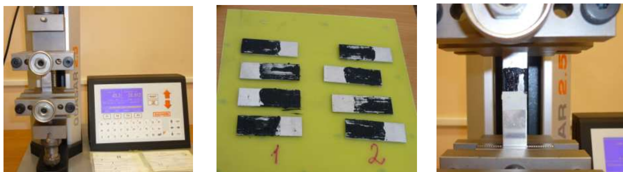
Фото №47-49. Испытание образцов на сдвиг. Использовалась разрывная машина QUASAR 2,5. На мониторе набиралась площадь сцепленных поверхностей, машина выдала нагрузку. При которой происходило расслоение пластинок.
