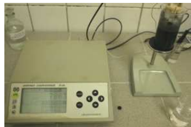
Фото №80-82. Тщательное перемешивание образцов с 1 молярным раствором KCl. Определение рН среды.
