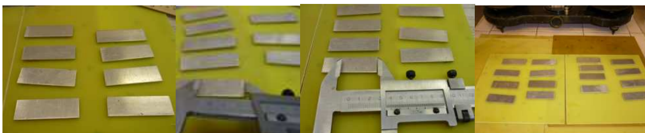
Фото №24-27. Определение сдвига. Подготовка образцов. Брали пластинки из алюминиевого сплава размером 20×60 мм, обезжировали бензином, с помощью штангенциркуля отмечали площадь поверхности, на которую наносится испытуемый материал.
