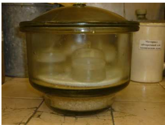
Фото №7,8. Это пустые бюксы в эксикаторе после высушивания. Охлаждают так, чтобы они не набрали лишней воды из воздуха.
