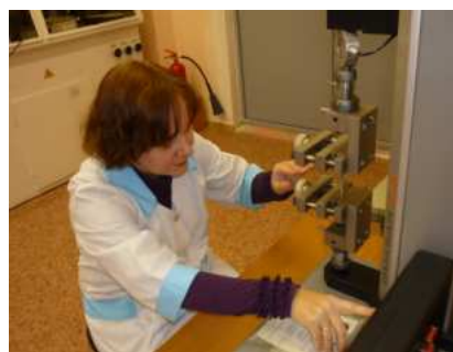
Фото №56-68. Изготовление образцов для испытаний и сами испытания проб на сдвиг. Храмкина С.Б.
