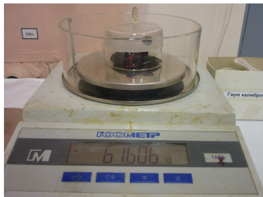
Фото №17,18. Взвешивание проб в бюксах перед сушкой.
