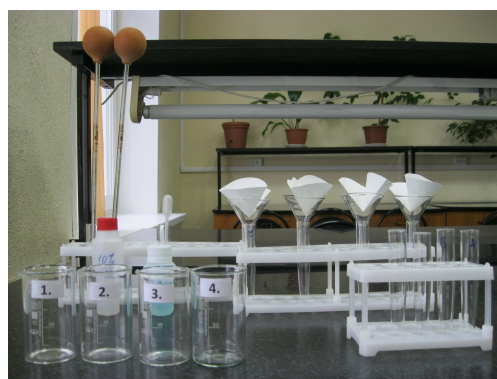
Фото №86-87. Подготовка к опыту для определения наличия белка. Получение фильтрата №1.
