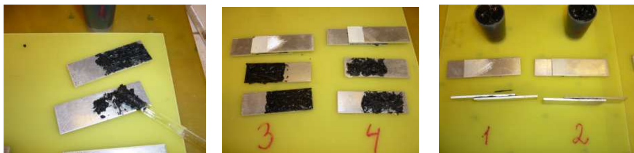
Фото №40-46. Изготовление образцов для определения сдвига. Грязь наносилась с помощью стеклянной палочки на поверхности обеих пластинок, пластинки соединялись и слегка притирались друг к другу, чтобы увеличить сцепление. Перед испытанием образцы выдерживались в течение 15 мин. На каждую пробу 2 образца.
