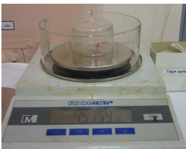
Фото №9-12. Взвешивание пустых бюксов на весах ВЛТЭ-310 с точностью до третьего знака после запятой.
