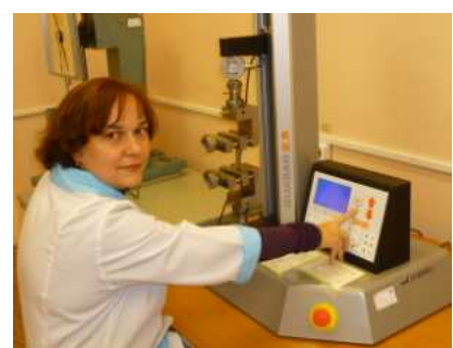
Фото №56-68. Изготовление образцов для испытаний и сами испытания проб на сдвиг. Храмкина С.Б.
