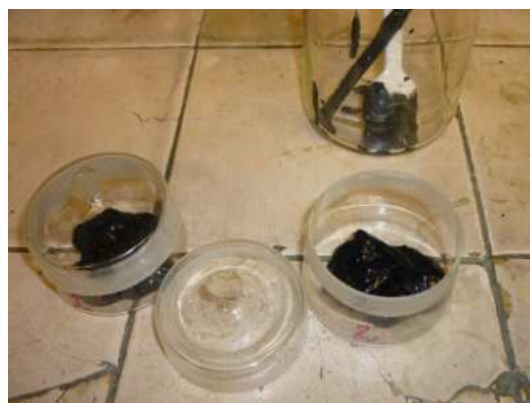
Фото №13-16. Отбор навесок испытуемого материала с помощью шпателя и стеклянной палочки.
