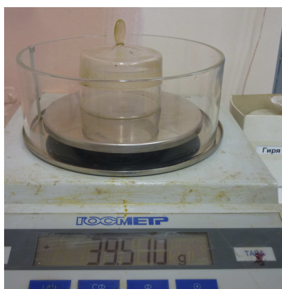
Фото №9-12. Взвешивание пустых бюксов на весах ВЛТЭ-310 с точностью до третьего знака после запятой.
