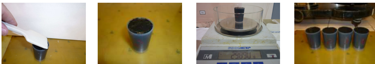
Фото №36-39. Заполнение стаканчиков материалом и последовательное взвешивание.
