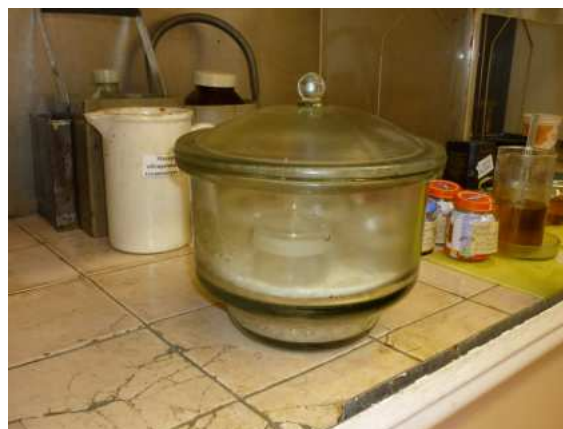
Фото №7,8. Это пустые бюксы в эксикаторе после высушивания. Охлаждают так, чтобы они не набрали лишней воды из воздуха.
