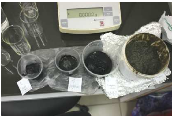
Фото № 73,74. Подготовка образцов к определению рН. Лаборатория СЭС г. Заречного.
