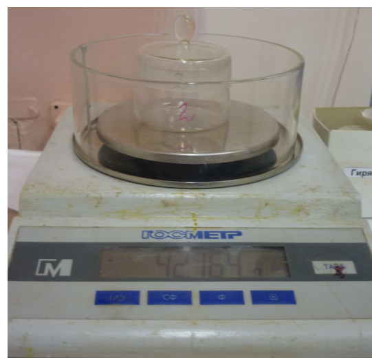
Фото №9-12. Взвешивание пустых бюксов на весах ВЛТЭ-310 с точностью до третьего знака после запятой.
