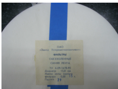
Фото №83. Обеззоленный фильтр. Фото №84. Реактивы для опыта.
