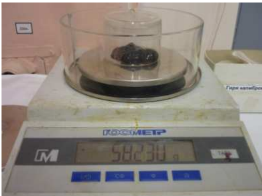
Фото №17,18. Взвешивание проб в бюксах перед сушкой.
