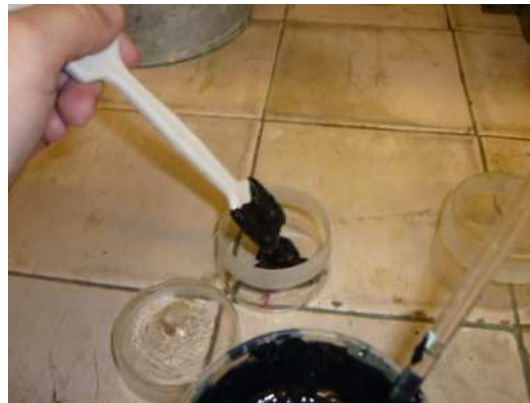
Фото №13-16. Отбор навесок испытуемого материала с помощью шпателя и стеклянной палочки.
