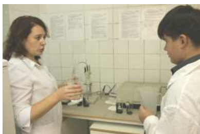
Фото №80-82. Тщательное перемешивание образцов с 1 молярным раствором KCl. Определение рН среды.
