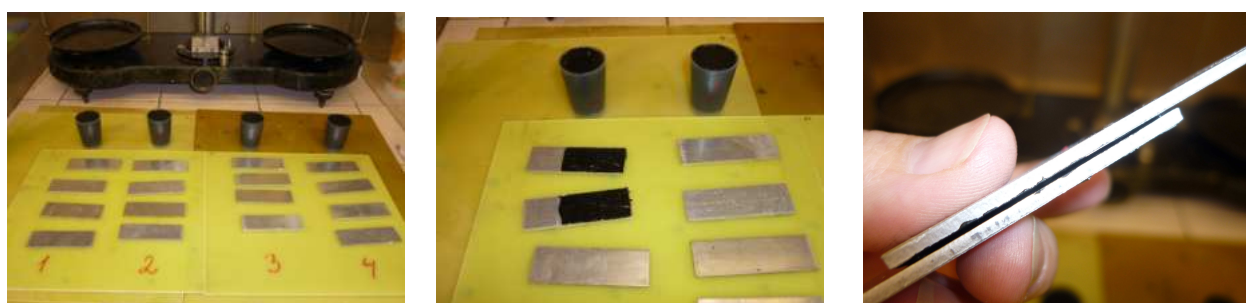
Фото №40-46. Изготовление образцов для определения сдвига. Грязь наносилась с помощью стеклянной палочки на поверхности обеих пластинок, пластинки соединялись и слегка притирались друг к другу, чтобы увеличить сцепление. Перед испытанием образцы выдерживались в течение 15 мин. На каждую пробу 2 образца.
