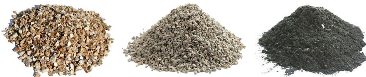
Рис. 6. Сорбенты, используемые в экспериментах (Верма-сорб (вермикулит), ЦТР-Сорб (цеолит) и Ol-Ex Hard (глинистый сланец).
