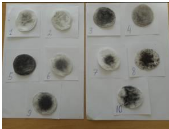
Рис.9. Результаты исследования после фильтрации проб талой воды в точках взятия проб
