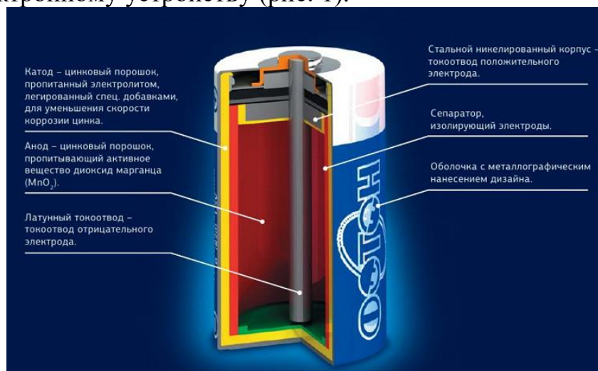
Рис. 1. Устройство солевой батарейки
