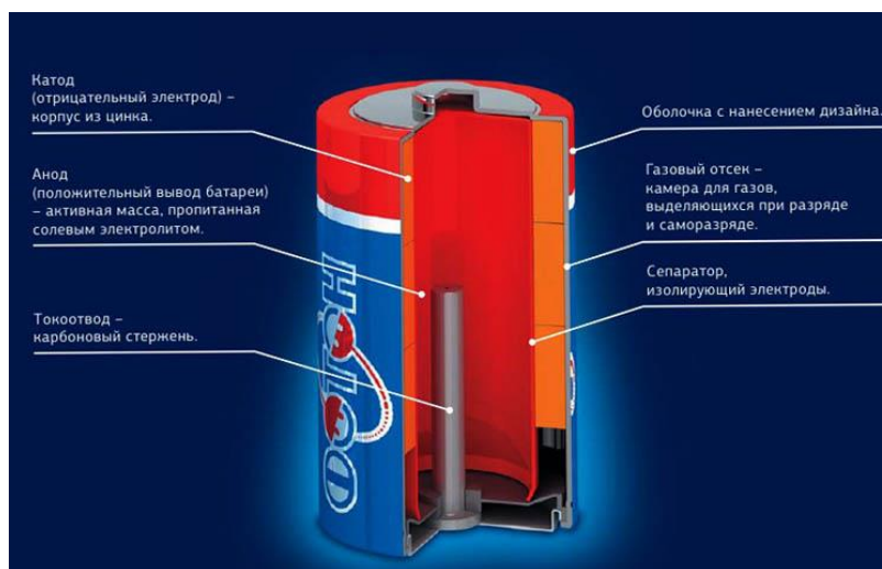
Рис. 2. Устройство алкалиновой батарейки
