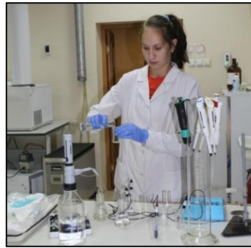
Рис.11. Определение нитратов потенциометрическим методом
