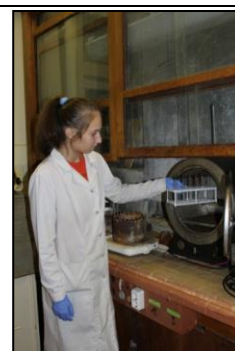
Рис.9. Определение бихроматной окисляемости спектрофотометрическим методом
