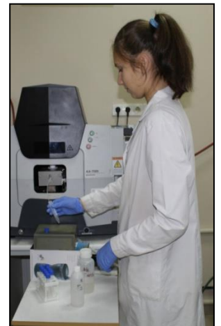
Рис.11. Определение нитратов потенциометрическим методом
