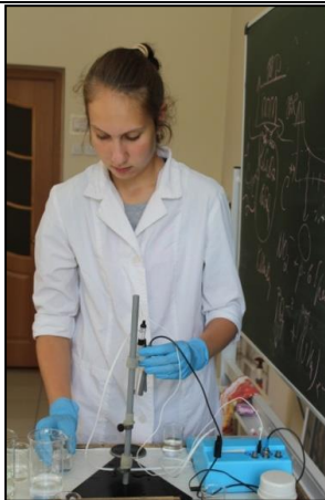
Рис.12. Определение хлоридов потенциометрическим методом
