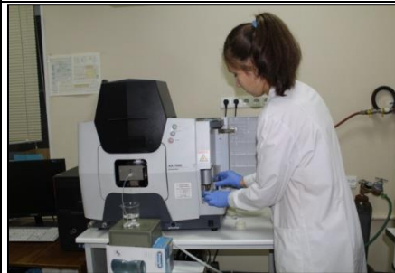
Рис.13. Определение металлов атомно-эмиссионным и атомно-абсорбционным методами
