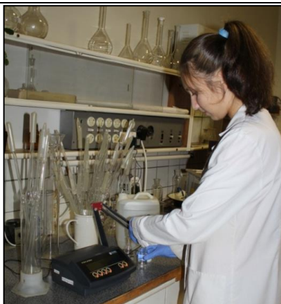
Рис.14. Определение pH потенциометрическим методом
