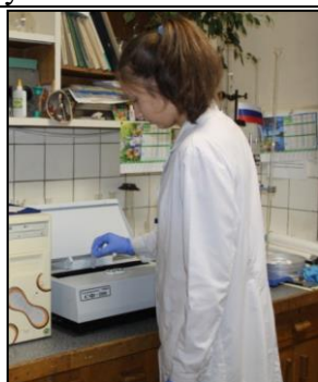
Рис.8. Определение мутности спектрофотометрическим методом
