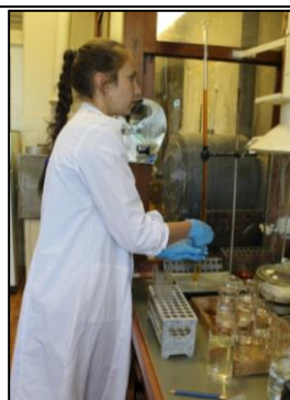
Рис.9. Определение бихроматной окисляемости спектрофотометрическим методом
