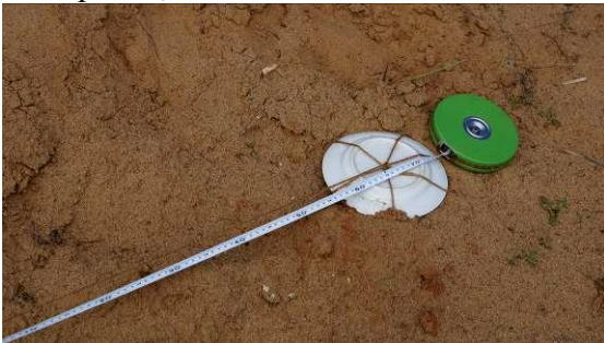
41.Диск для измерения прозрачности воды
