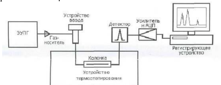
Рис. 3. Схема устройства хроматографа.
