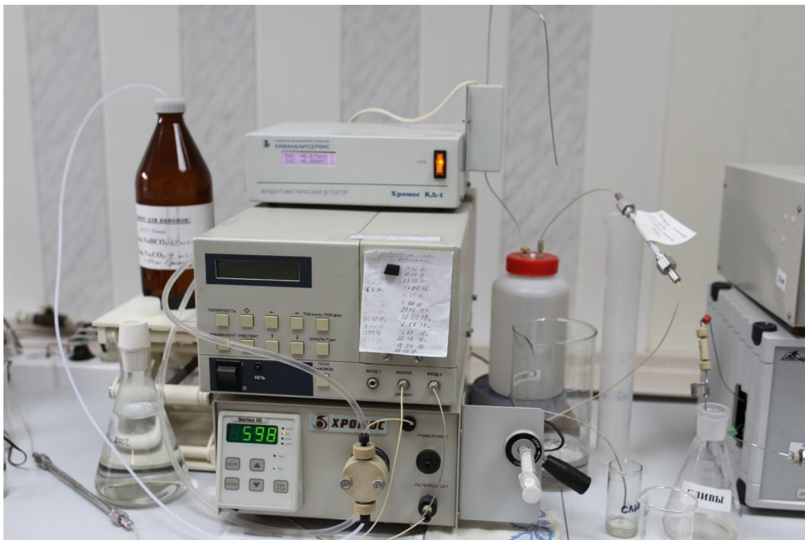
Рис.1 Жидкостный хроматограф "Хромос ЖХ - 301".
