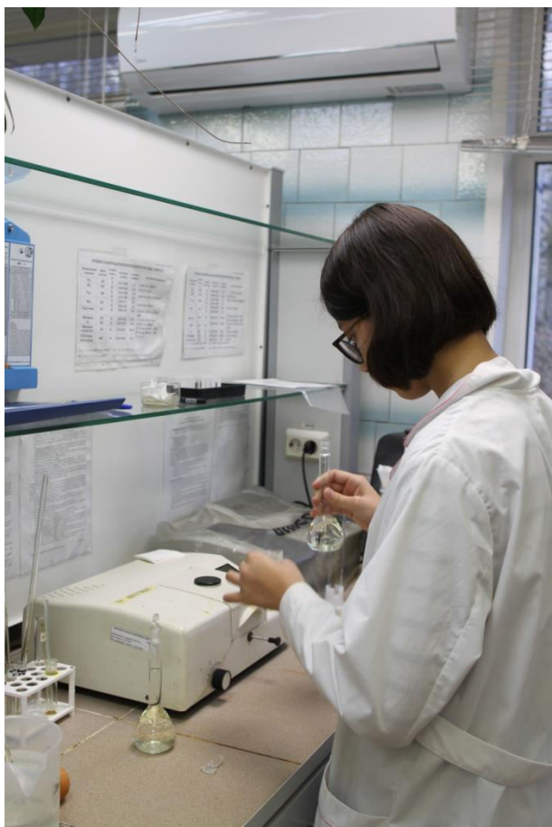
Рис. 7 Проведение гидрохимического анализа, на концентрацию ионов аммония в пробе.
