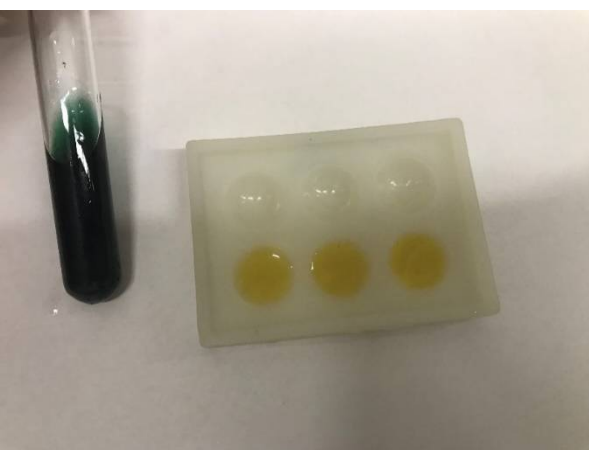
Фото 19. Сравнение осадка \text{Fe}_4[\text{Fe}(\text{CN})_6]_3 с кислотной вытяжкой
