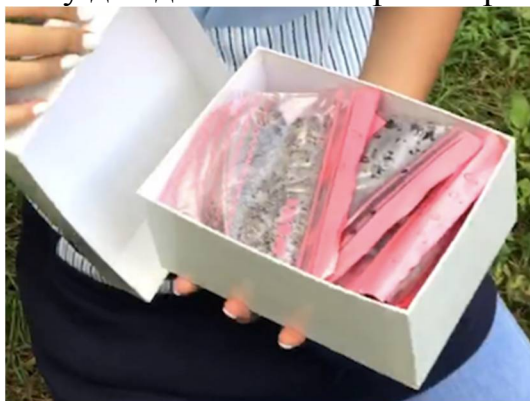
Рисунок 12. Отобранные пробы почвы, упакованные в zip-пакеты и транспортную коробку
