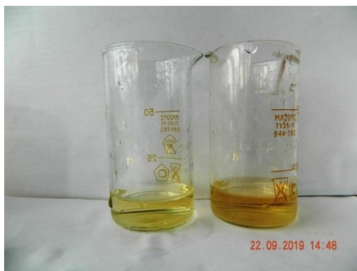
Рис. 9. Титрование по метилоранжу в присутствии контрольной пробы
