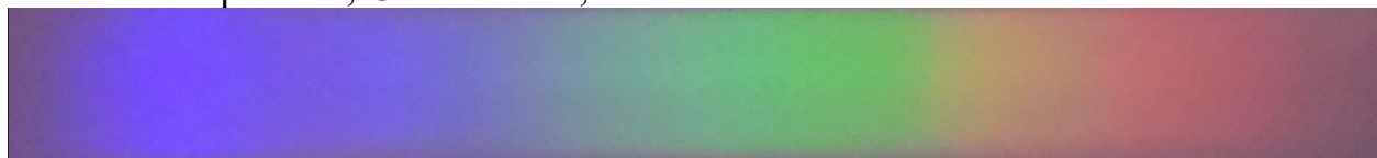
Рисунок 2.2 – Спектр используемого светодиода LS603 SMD2835, полученный при помощи дифракционной решетки
