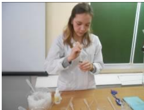
Рис. 12. Добавление к перекиси водорода раствора пищевого продукта Присоединяла каталазник к прибору, устанавливала нулевую точку жидкости в бюретке. Быстро сливала и перемешивала растворы в одном из колен каталазника. Через каждые 5 мин в течение 20 мин отмечала объем кислорода, который выделяется в процессе ферментативной реакции (рис. 13, 14, 15).
