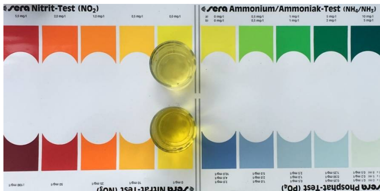
Рис. 2 Тестирование пробы на содержание соединений азота.
