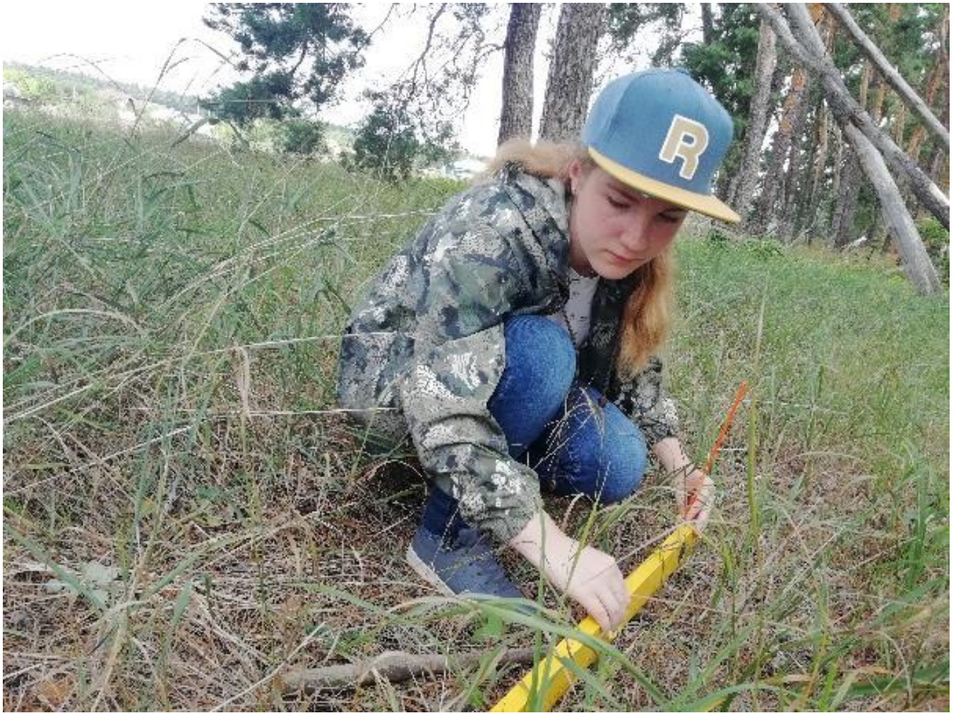
Рис. 12. Измерение склона методом ватерпаса (фото из архива геоэкологического объединения «Варварино») **
