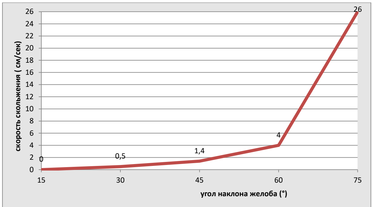
Рис. 2.1.3 Скорость скольжения блоков в зависимости от угла наклона в эксперименте
