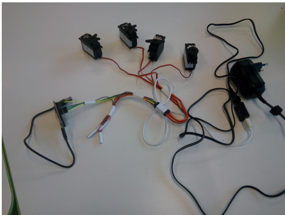
Рис. 7. Электронная схема управления сервоприводами для реализации первого способа опрыскивания корневой системы растения.
