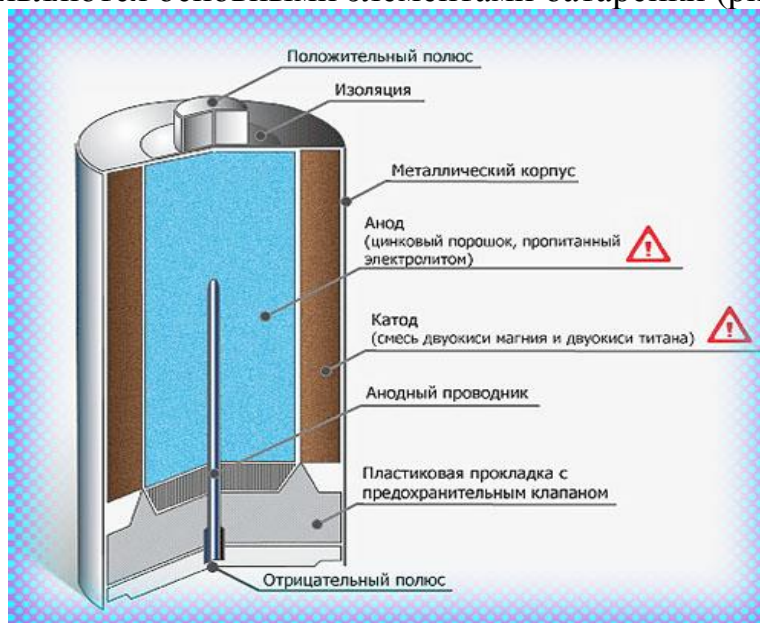
Рис. 1. Устройство батарейки
