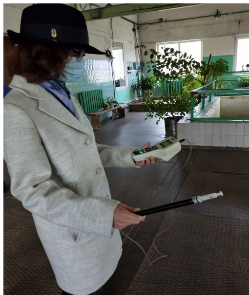
Приложения 7-10 Измерения радона в воздухе. На станции «Товарная»
