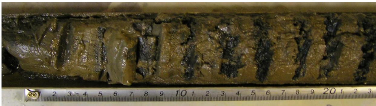
Рис. 2. Слоистость донных отложений оз. Раифское
