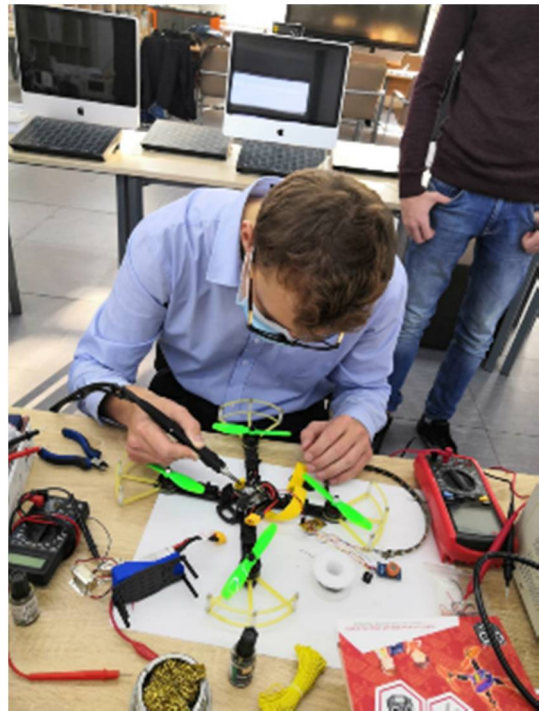
Рис. 3. Пайка датчика газоанализатора к одноплатному компьютеру
