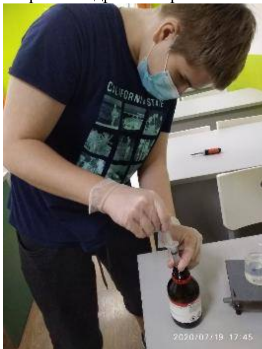
Рис. 8. Получение этанольного раствора \text{Si}(\text{OH})_4 : отбор реагента (а) и осаждение под контролем рН-метра (б)
