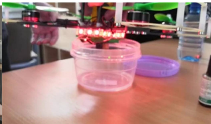
Рис. 6. Пары летучих веществ были обнаружены датчиком и визуализированы переключением зелёного цвета светодиодной ленты (а) на красный (б)
