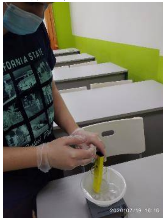
Рис. 8. Получение этанольного раствора \text{Si}(\text{OH})_4 : отбор реагента (а) и осаждение под контролем рН-метра (б)
