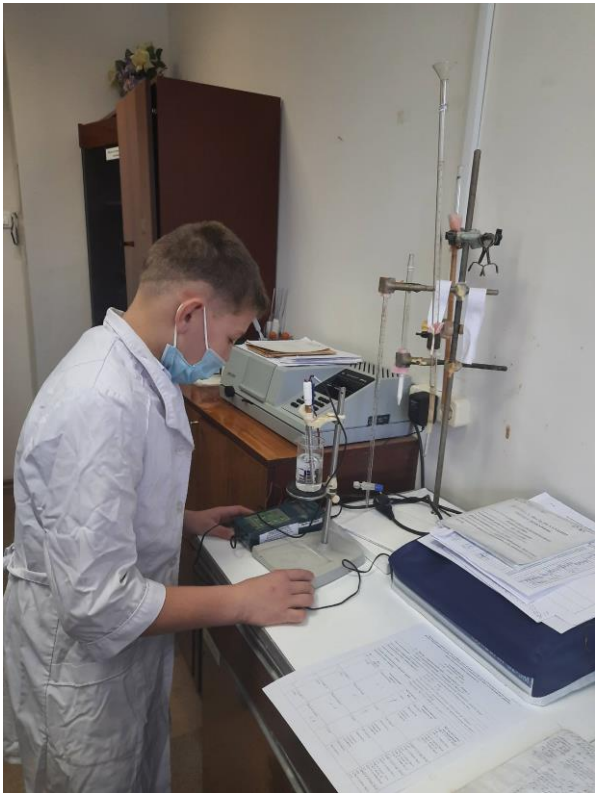
Рисунки 5-6 Химический анализ воды оз. Тамбукан (потенциметрическое определение pH и определение концентрации ионов на ФЭК)
