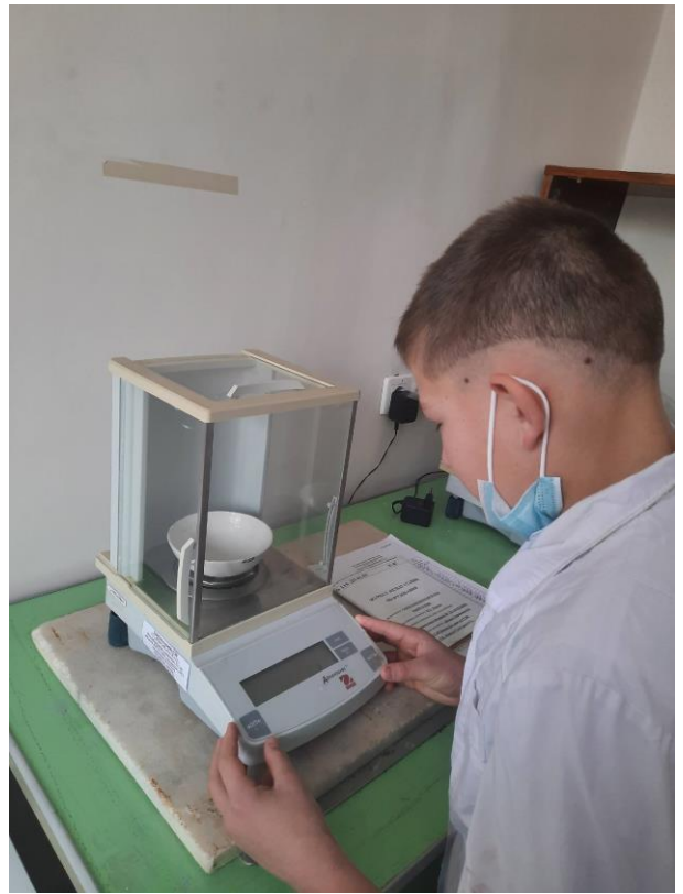
Рисунки 7-8 Работа в лаборатории санитарно-эпидемиологической станции определение сухого остатка и минерализации.
