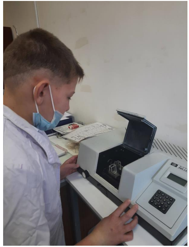
Рисунки 5-6 Химический анализ воды оз. Тамбукан (потенциметрическое определение pH и определение концентрации ионов на ФЭК)
