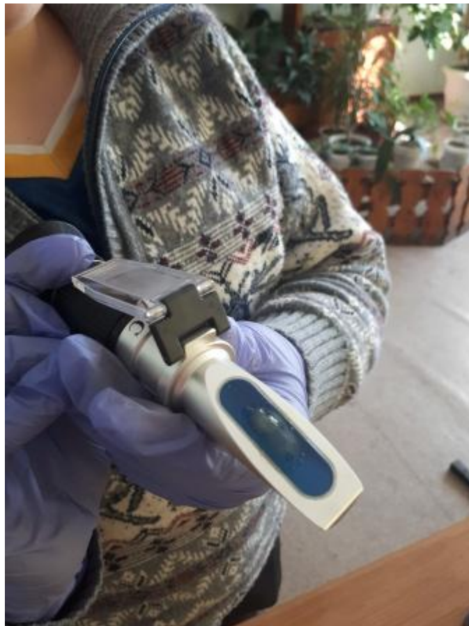
Фото №6. Определение содержания воды в меде рефрактометром
