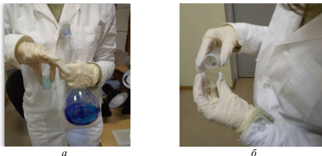
Рис. 12. Раствор MeB до и после процесса Фентона в присутствии образца Fe_xO_y/HCR (а); помещение раствора MeB в кювету спектрофотометра (б)
