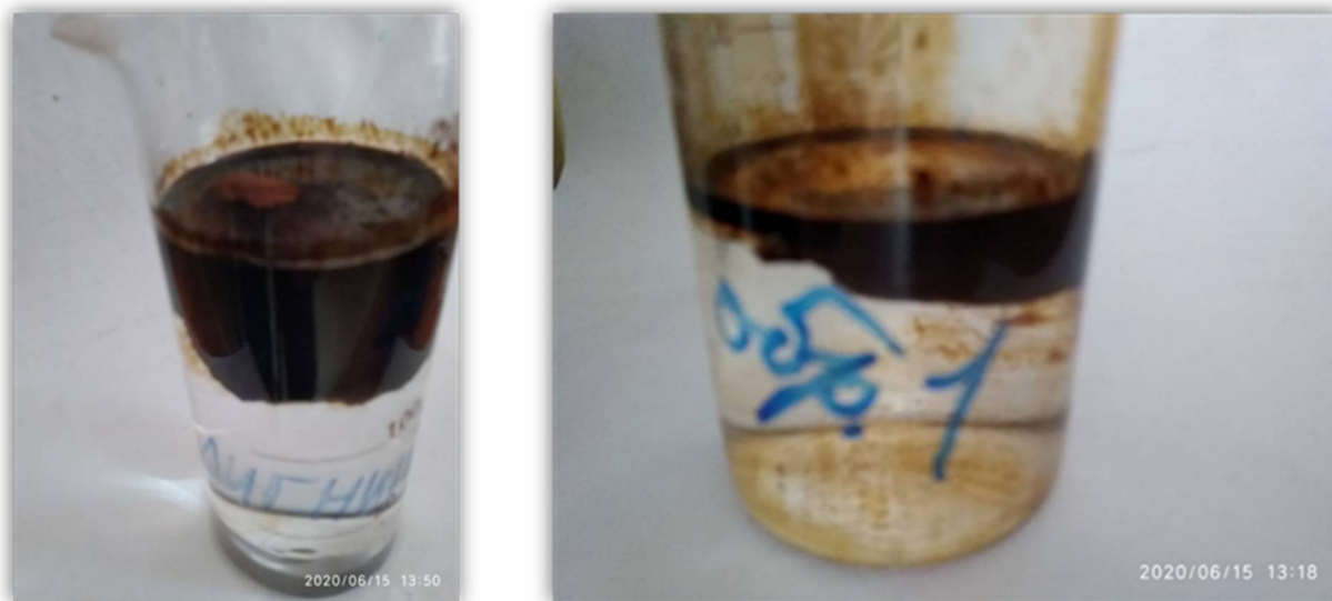
Рис. 11. Обычный лигнин после поглощения нефти частично утонул (а), лигнин с магнетитом в тех же условиях не утонул (б)
