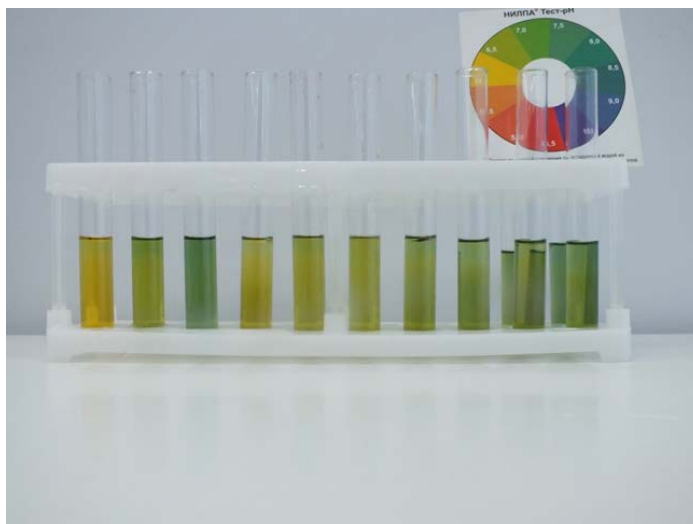
Рис. 7. Результаты измерения pH разных проб с помощью теста «Нилпа»
