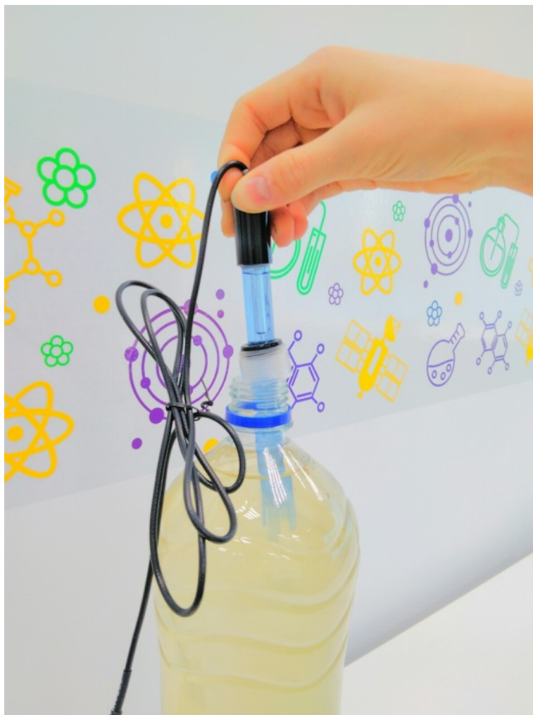
Рис. 12. Датчик измерения водородного показателя (рН)
