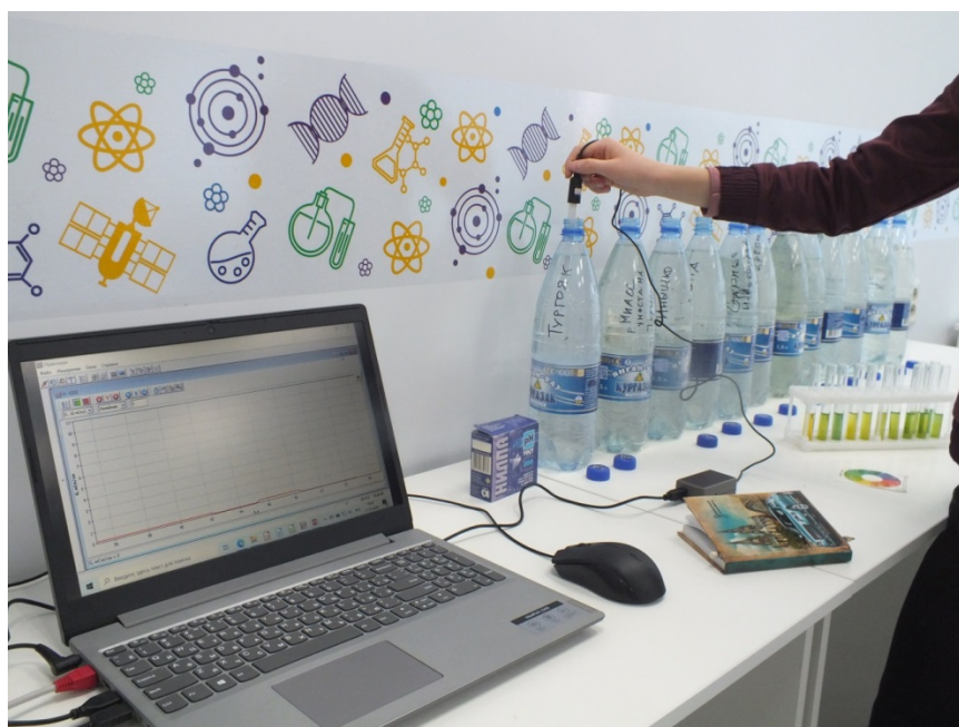
Рис. 8. Измерение показаний рН с помощью датчика
