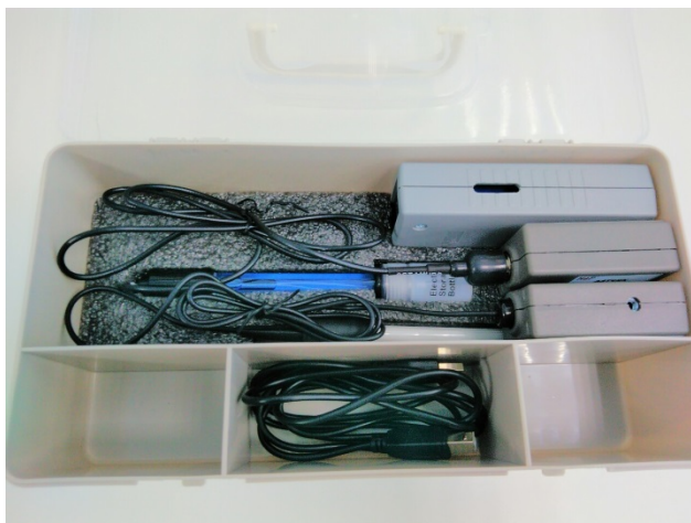
Рис. 4. Набор датчиков для экологического мониторинга «Экологический патруль»
