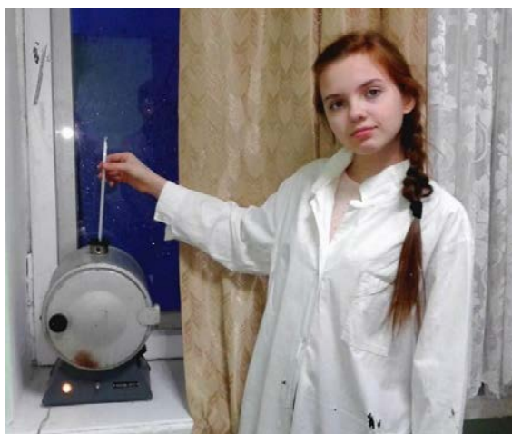
Фото 12. Термообработка окрашенных образцов халцедона в сушильном шкафу
