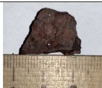
Фото 64. Образцы халцедона после окраски нитратом железа (III) с гексоцианофератом калия и обжиге при 800^\circ
