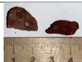
Фото 63. Образцы халцедона после окраски нитратом железа (III) и термообработки при 800^\circ
