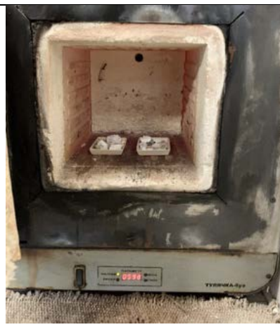
Фото 14. Нагревание халцедона в муфельной печи
