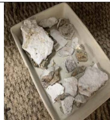
Фото 15. Образцы халцедона после обжига при 800°
