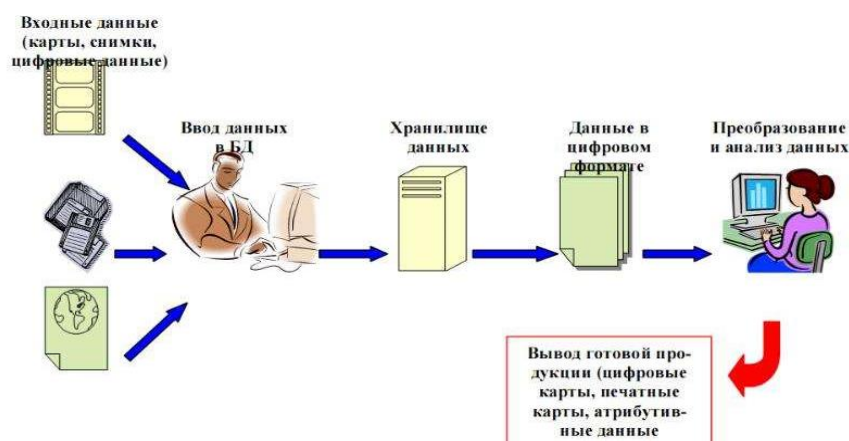
Рисунок 2 – Процесс создания и преобразования цифровых карт
