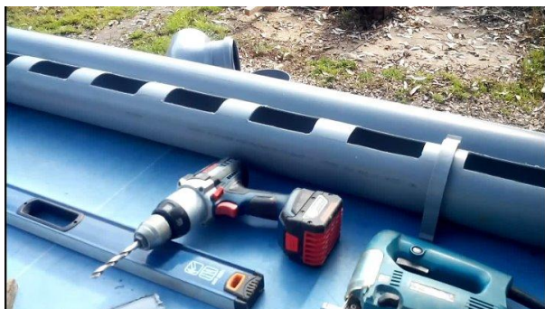
Фото 3 Кормушка из пластиковой канализационной трубы
