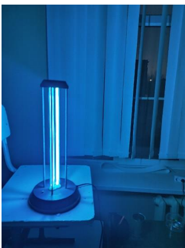
Фото10. Ультрафиолетовый бактерицидный светильник-облучатель открытого типа UGL-TO1A (Uniel)
