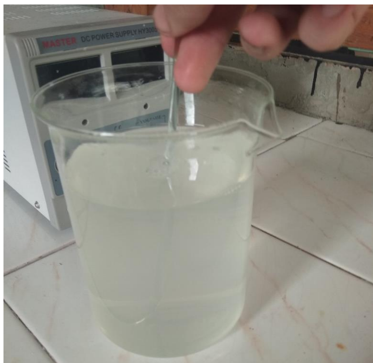
Рисунок 2.1 – Получение 40%-ого раствора гидроксида натрия
