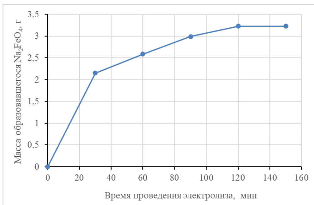
Рис. 3.1 – Зависимость массы образовавшегося феррата натрия от времени проведения электролиза
