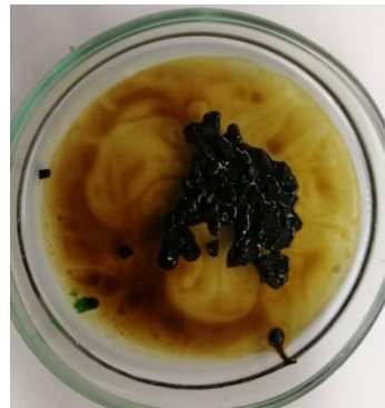
Нефтяное пятно после 15 минут контакта с резиновой крошкой (агломерат)
