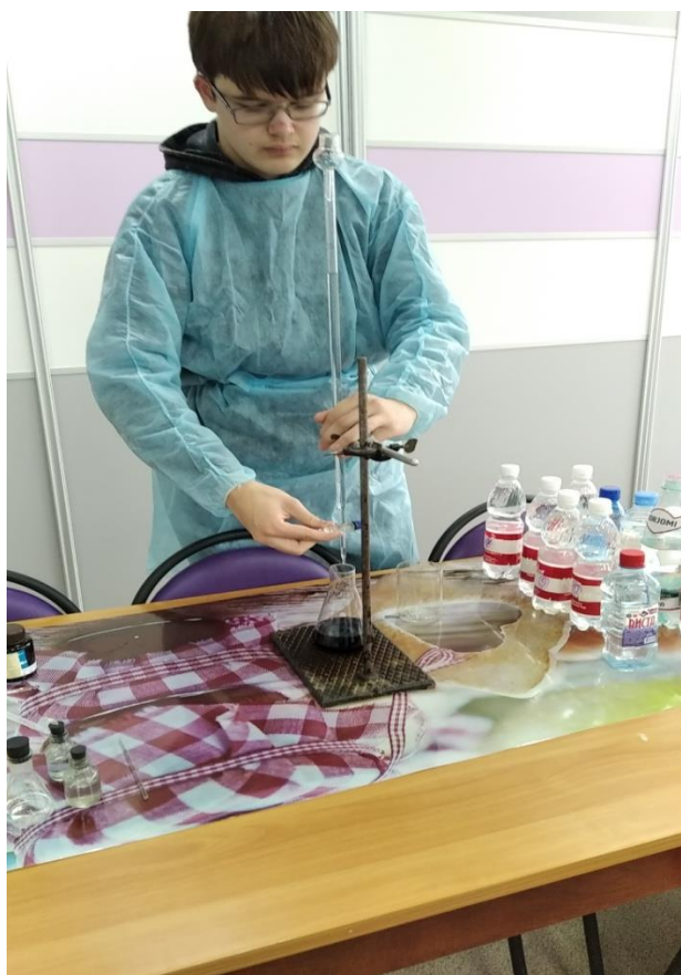
Рис.6 . Процесс титрования (бюретка с раствором трилона Б)
