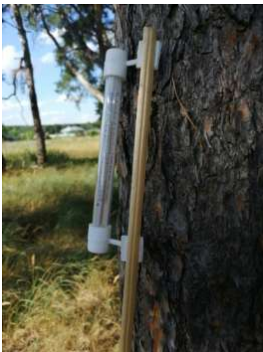
Рис.19. Оборудование. Воздушный термометр для измерения температур на уровне 2м.*
