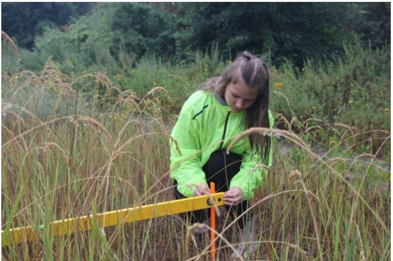
Рис.23. Измерение склона методом ватерпасовки. *
