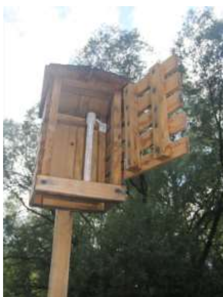
Рис.21. Оборудование. Метеобудка для измерения температур на уровне 2м
