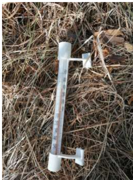
Рис.20. Оборудование. Воздушный термометр для измерения температур на уровне почвы*
