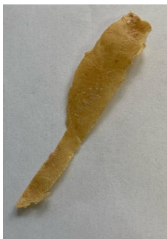
Рис. 6: Вид пленки до (а) и после (б) компостирования в течение 4-х недель
