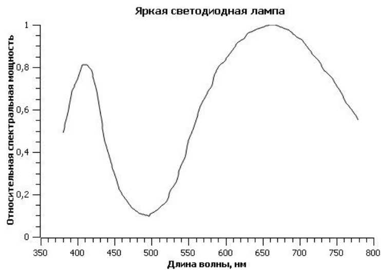
Рис. 2.3. Распределение энергии в спектре яркой светодиодной лампы
