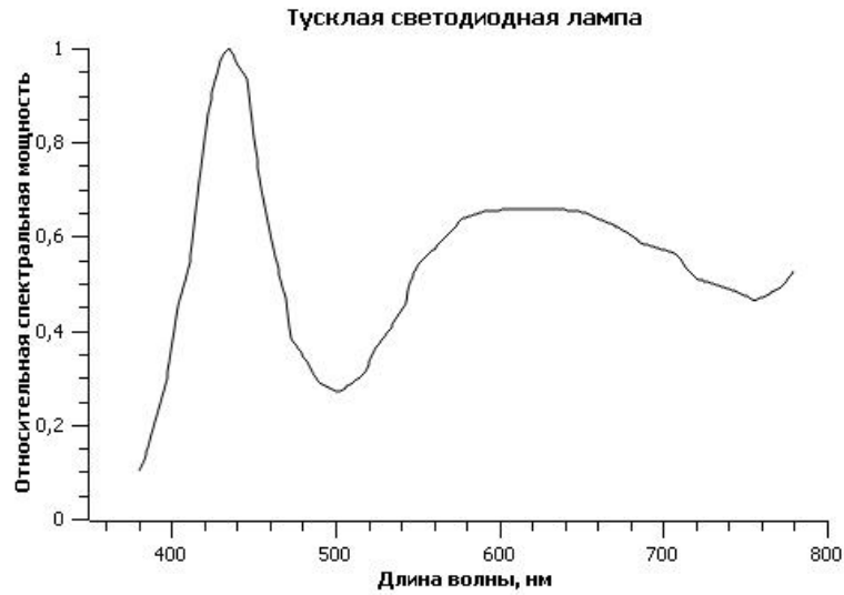
Рис. 2.4. Распределение энергии в спектре тусклой светодиодной лампы
