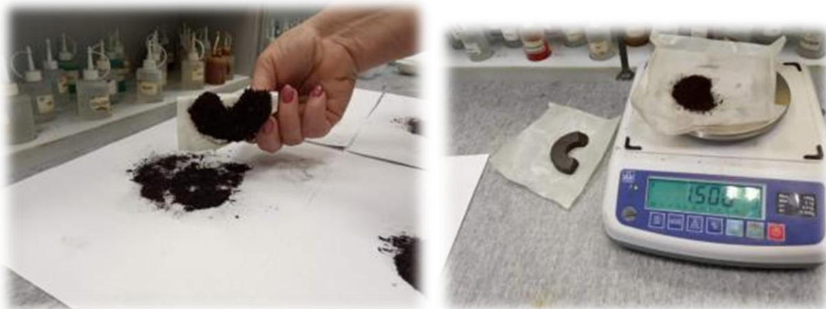
Рис.7. Определение магнитных свойств сорбентов.
