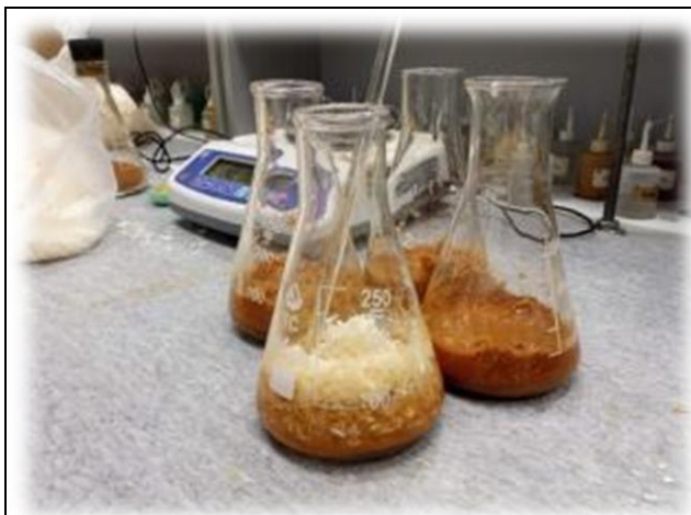
Рис.1. Обработка опилок суспензией гетита
