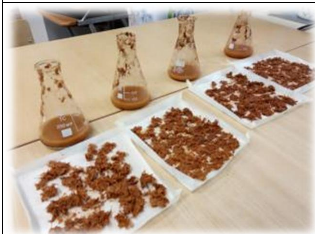
Рис. 3. Высушивание пропитанных гетитом опилок.
