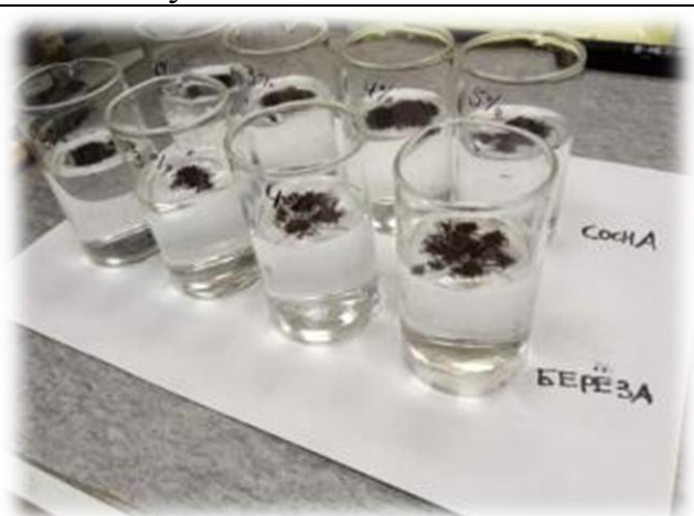
Рис.4. Определение плавучести гидрофобизированных сорбентов.
