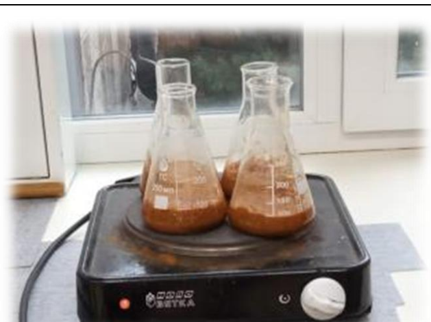
Рис.2. Нагревание смеси опилок и водной суспензии гетита на плитке
