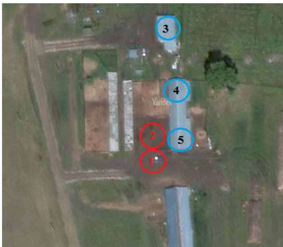
Рисунок 4 Предполагаемое место установки ветрогенератора: 1 – ветрогенератор; 2 – насос; 3 – доильный цех; 4 – охладитель; 5 – пастеризатор
