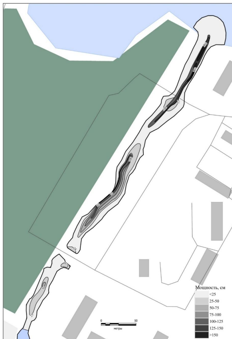
Рис. 5. Карта-схема мощности донных отложений в Монастырской протоке
