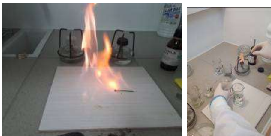
Рис. 12 Обжигание (ФЛАМБИРОВАНИЕ) кафельной плитки и инструмента
