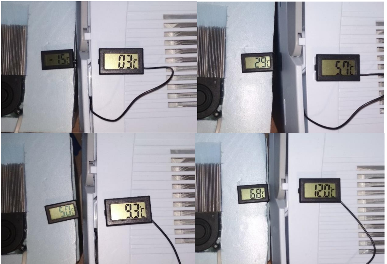
Рис. 15. Сравнение температуры в автохолодильниках
