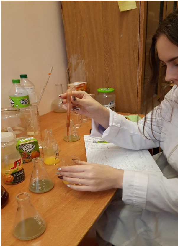
Фото 5. Проведение титриметрического анализа методом йодометрии
