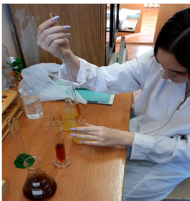
Фото 2 и 3. Проведение титриметрического анализа методом йодометрии
