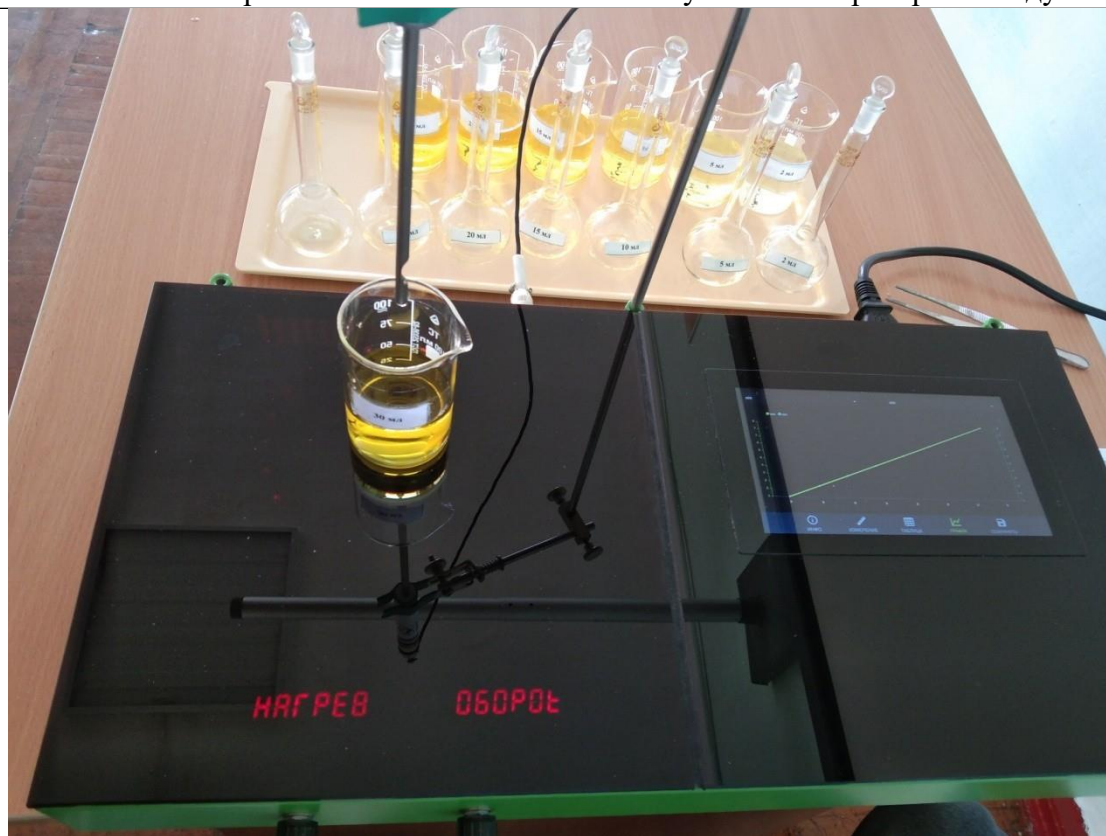
Рис.5-6 Измерение оптической плотности на учебно-лабораторном модуле «Экология»
