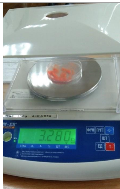
Рис. 1 Взвешивание бихромата калия на аналитических весах
