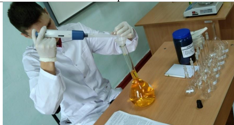
Рис. 3 Приготовление стандартного раствора бихромата калия
