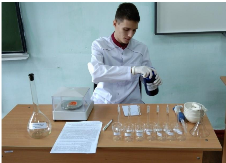
Рис. 1 Взвешивание бихромата калия на аналитических весах
