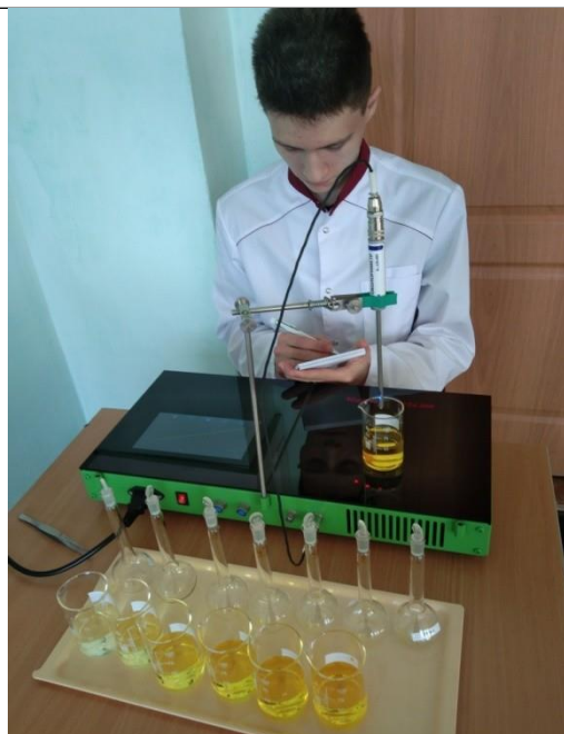
Рис.5-6 Измерение оптической плотности на учебно-лабораторном модуле «Экология»
