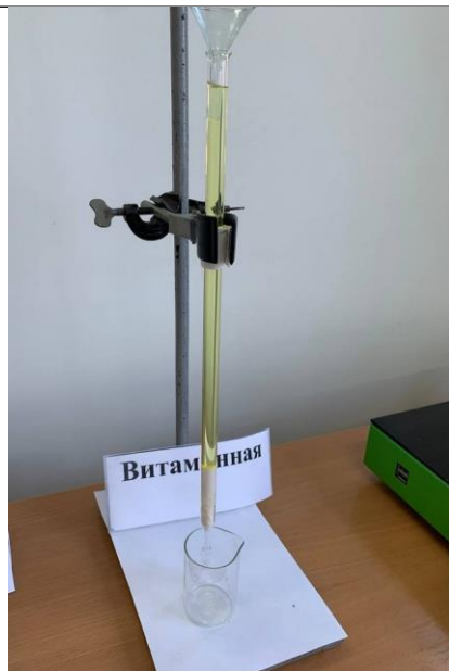
Рис. 5-6 Проведение экстракта исследуемого сорта тыквы через адсорбент. Сбор 50 мл экстракта
