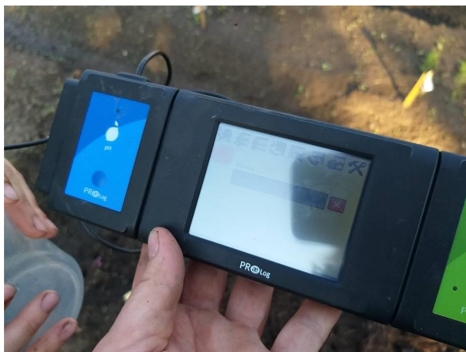
Рисунок 1.3 – Определение кислотности почвы при помощи модуля pH
