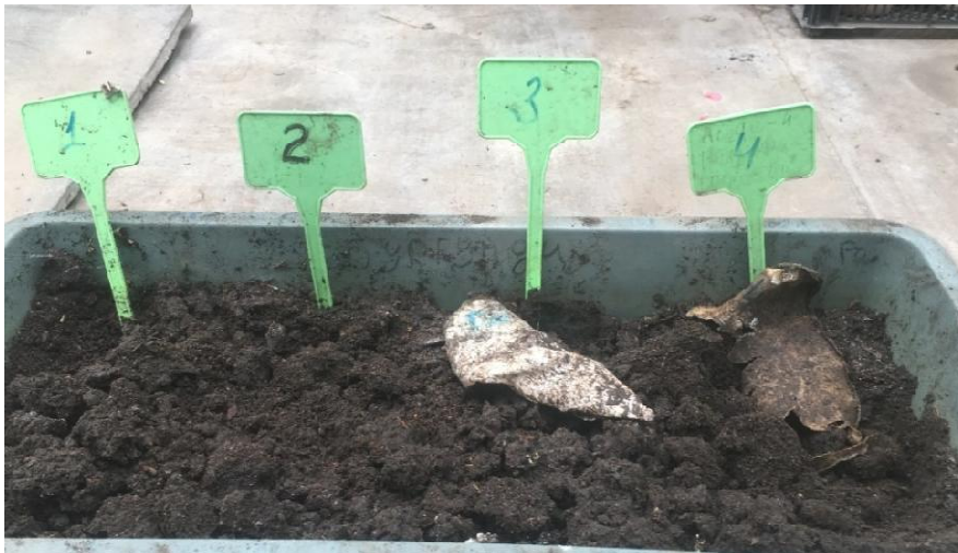
Рис. 4. Образцы композитов ПВС-1799 + крахмал и ПВС-1799 + целлюлоза, после 5 месяцев содержания в почве.
