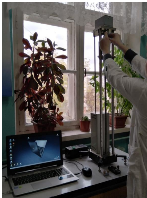
Рис. 1. Машина разрывная РМ-50 с программным обеспечением «StretchTest»
