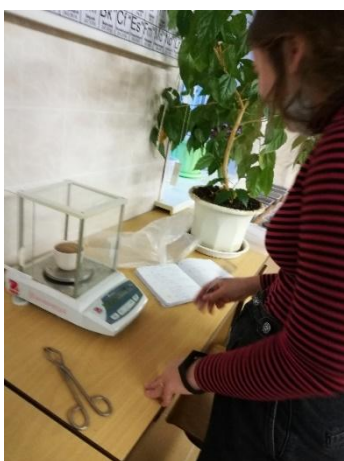
Рис. 7. Определение содержания гумуса (а – взвешивание тигля с почвой; б – помещение тигля с почвой в муфельную печь)
