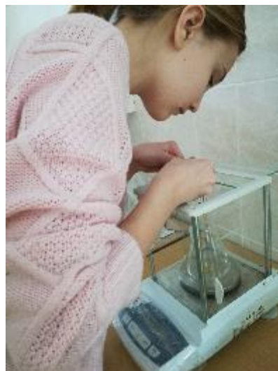
Рис. 3. Определение йодного числа. Добавление масла в колбу
