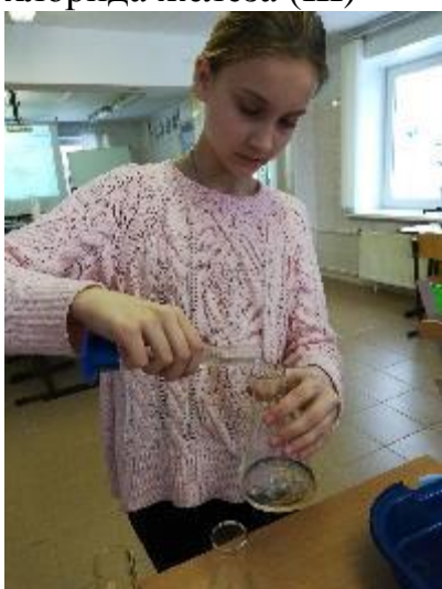
Рис. 4. Определение йодного числа. Добавление спирта
