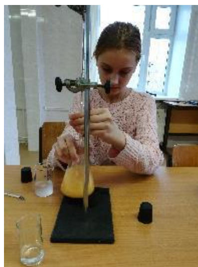
Рис. 5. Определение йодного числа. Титрование спиртового раствора масла раствором тиосульфата натрия
