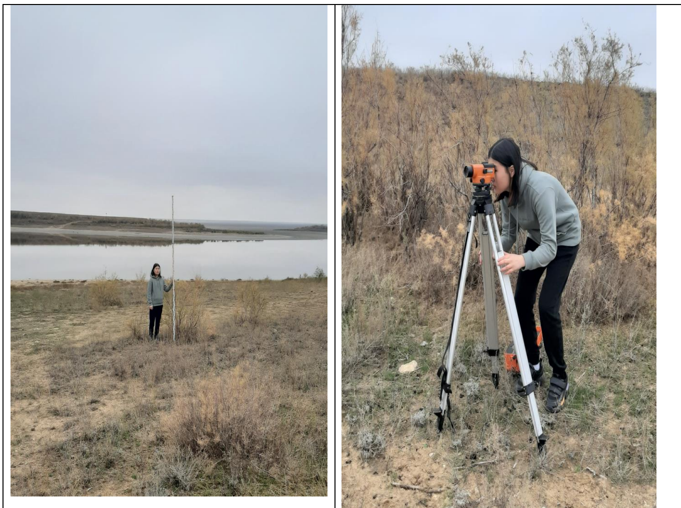
Рис. 5 Измерение отметок высот с помощью рейки и нивелира на ключевом участке исследования.
