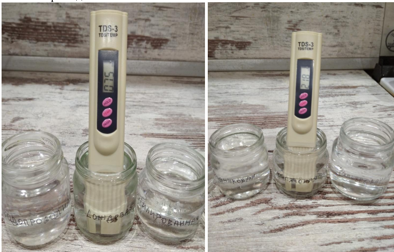
Фото №10. Опыт №3. Сравнение качества воды с помощью электронного анализатора воды TDS meter 3
