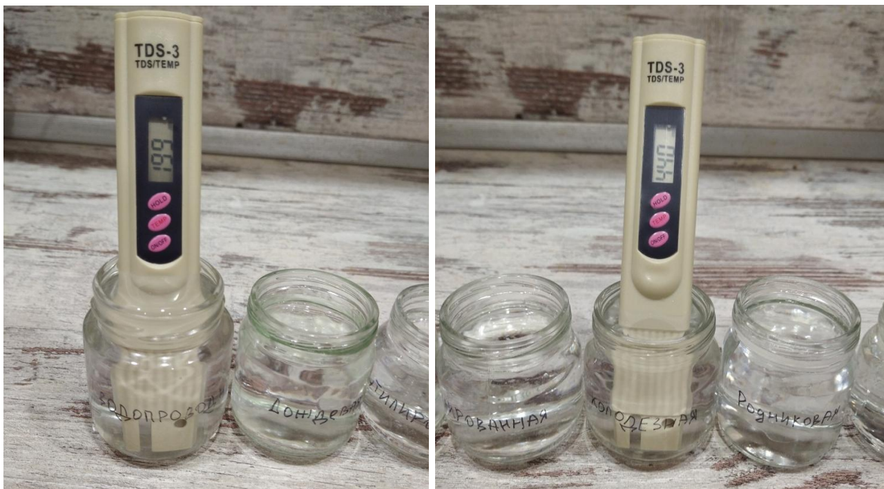
Фото №9. Опыт №3. Сравнение качества воды с помощью электронного анализатора воды TDS meter 3
