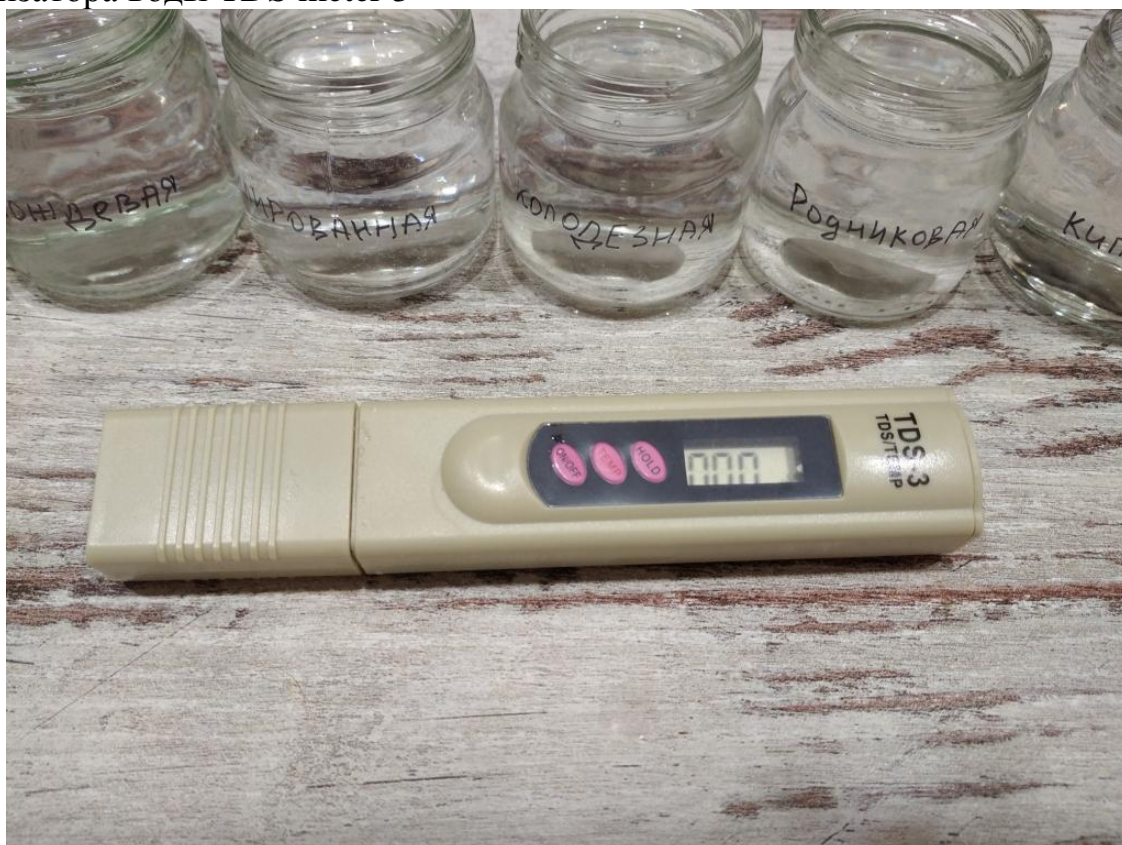
Фото №8. Опыт №3. Сравнение качества воды с помощью электронного анализатора воды TDS meter 3
