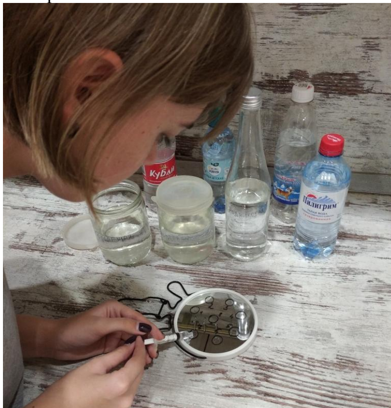
Фото №5. Опыт №2. На определение, оставит ли чистая вода след на зеркале, если её испарить
