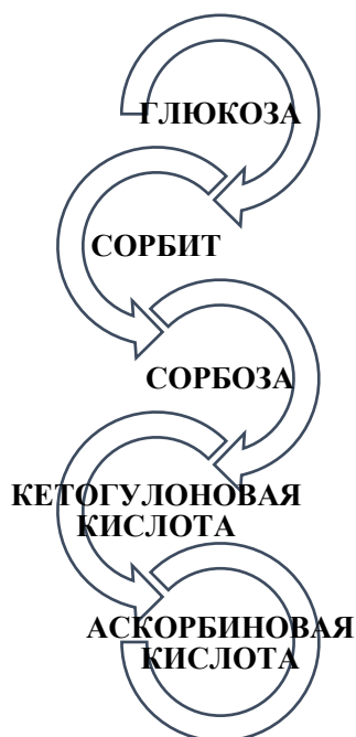
Рисунок 3. Схема процесса получения аскорбиновой кислоты
